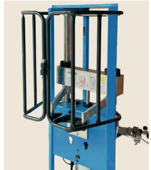
**IN CASO DI PROTEZIONE APERTA LA MACCHINA È DOTATA DI UNA VALVOLA DI INTERBLOCCO CHE NE IMPEDISCE IL FUNZIONAMENTO**
