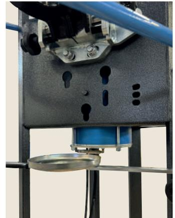
**POSSIBILITÀ DI DOPPIO POSIZIONAMENTO DELLA STAFFA** per disporre di maggiore spazio e corsa per la compressione delle molle extra lunghe
