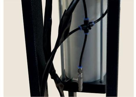
**CILINDRO IN LEGA LEGGERA DI ALLUMINIO, RESINA DI NYLON E FIBRA DI VETRO** impedisce la corrosione e l'ossidazione delle parti interne della macchina
