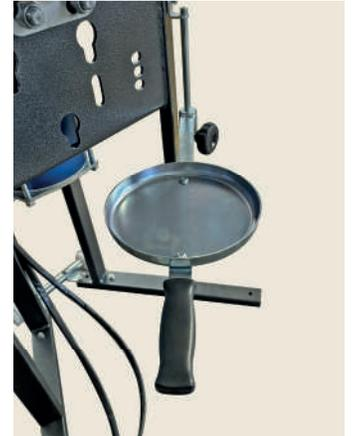
**SUPPORTO PARTE IDRAGICA AMMORTIZZATORE** per facilitare il lavoro di s/montaggio.
