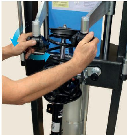
**MORSETTI FLOTTANTI**, per un miglior fissaggio sulla molla, con adattamento dinamico anche durante le diverse fasi di compressione
