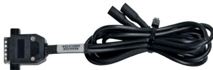
Cablaggio di emulazione, con la funzione di simulatore digitale di resistenza variabile da circa 100Ω a circa 25.000Ω per la simulazione dei sensori (es. sensore di temperatura motore, ecc).
