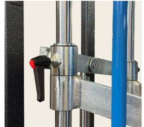
**LEVE DI SICUREZZA IN METALLO PER IL BLOCCAGGIO DELLA POSIZIONE DEI BRACCI**
