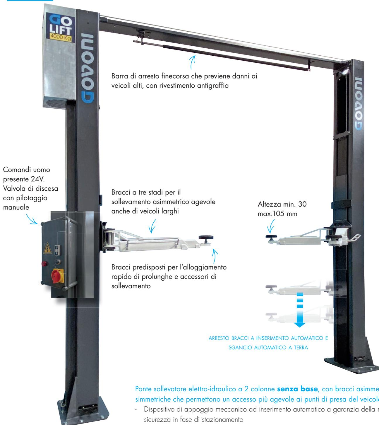
Ponte sollevatore elettro-idraulico a 2 colonne **senza base**, con bracci asimmetrici e colonne simmetriche che permettono un accesso più agevole ai punti di presa del veicolo.
